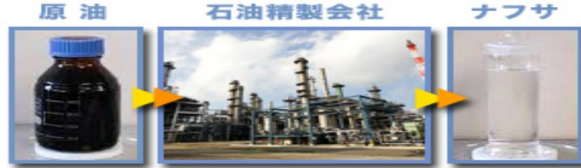
原油は、石油精製会社によって蒸留されナフサへと形を変え、丸善石油化学などの石油化学会社へと引き継がれる
