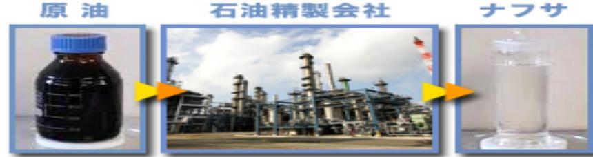
原油は、石油精製会社によって蒸留されナフサへと形を変え、丸善石油化学などの石油化学会社へと引き継がれる
